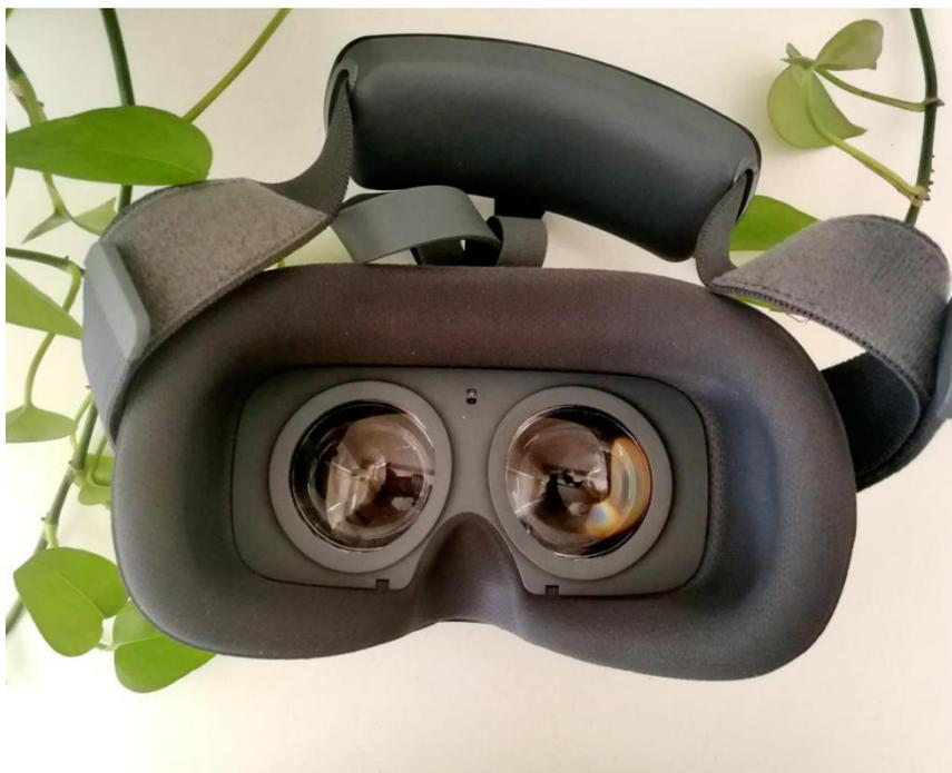
在产品参数上，Pico G2 4K 搭载高通骁龙™835 移动 VR 平台，4G+32G 内存，采用 4K 标准 RGB 子像素排列的 VR 定制屏，双目分辨率达到 3840x2160，PPI：818，使得屏幕硬件有效像素点数真正达到 4K 标准。具体参数如下：
