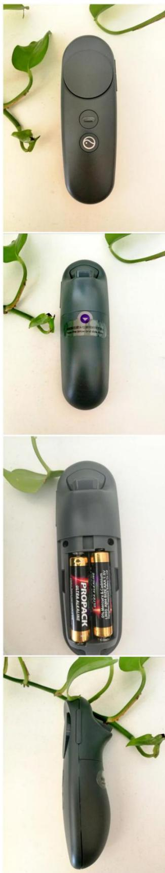
手柄是 VR 一体机重要的组成部分，Pico G2 4K 配备的是一款 3DoF 手柄，整体设计较为简单。正面有三个按键，中间圆形区域按键可以现实滑鼠的作用，向下依次是返回键、Home 键。手柄右侧是音量键，位于手柄正下方的是扳机键，扳机键的设计在一定程度上增强了射击游戏的真实体验感。此款手柄相较 Pico 之前发布的 G 系列产品手柄，在无线连接的稳定性和传感精度上都有了进一步的提升。另外，此款手柄通过两节 7 号电池供电，安装拆卸都较为方便。
