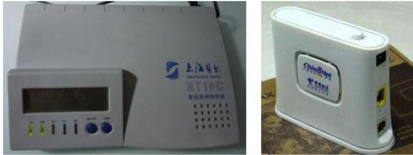
早期 ISDN 和 ADSL Modem，分别采用电话线和网线接入拨号上网
