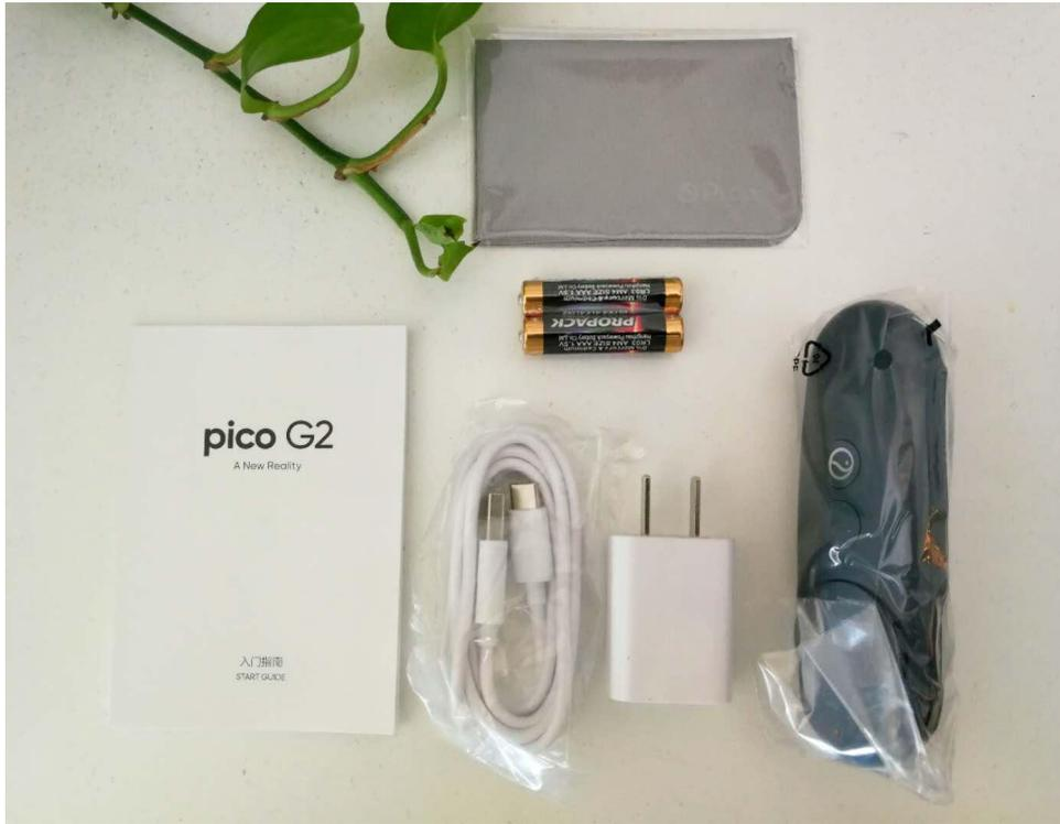
充电器型号为 5V/2A 的充电头，数据线是 Type-C 接口，手柄电池为七号电池，安装方便。
