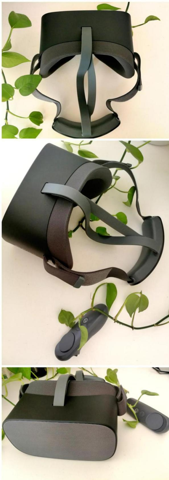
Pico G2 4K 在佩戴的设计上采用了软质绑带、自适应松紧设计，达到了较好的稳定性。头顶部由电源线和顶部绑带两层构成，电源线不可拆卸，而位于下层的绑带则可以拆卸更换。另外，两侧的绑带可以根据需求自行调节。
