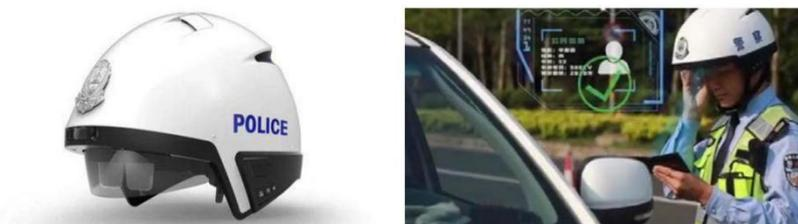
博鳌论坛 5G+AR 智慧安防解决方案，警察佩戴 5G AR 安防智能警用头盔，利用 5G 网络将视频画面或声音信息实时回传到指挥中心的云平台，再结合人工智能视频分析技术，将识别的车辆信息、人员信息和语音信息通过 5G 网络传回头盔，并与头盔 AR 眼镜中的目标物叠加呈现给警察，为现场执法提供实时的信息支持，使安防保障与区域管控的效率和准确性得到提升。
