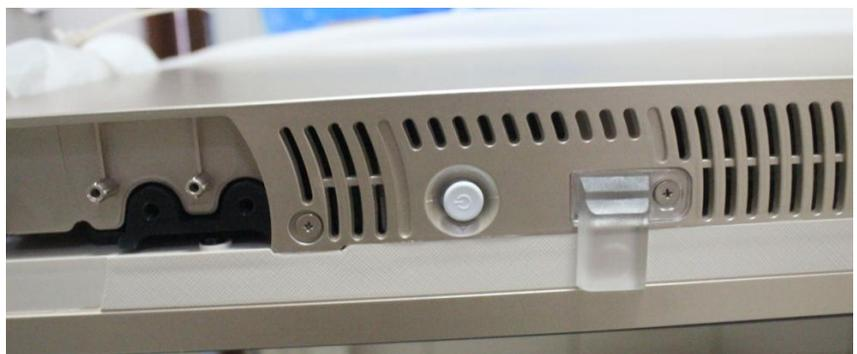
同时此款 55 寸的大电视可以进行壁挂方式，在其后背下部设有两个壁挂孔。
