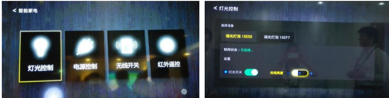
连接智能灯泡后，可以对灯光的开关、光线亮度进行调节
