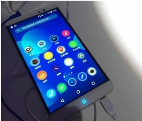
配置方面,二者均采用 6 寸 2K 分辨率 2.5D 曲面屏幕,搭载 2.0GHz 联发科 MT6795 处理器,搭配 3GB 内存、32GB 机身存储(支持 128GB 存储扩展),摄像头组合为 800 万像素前置+1300 万像素后置,配备 3610mAh 电池。
