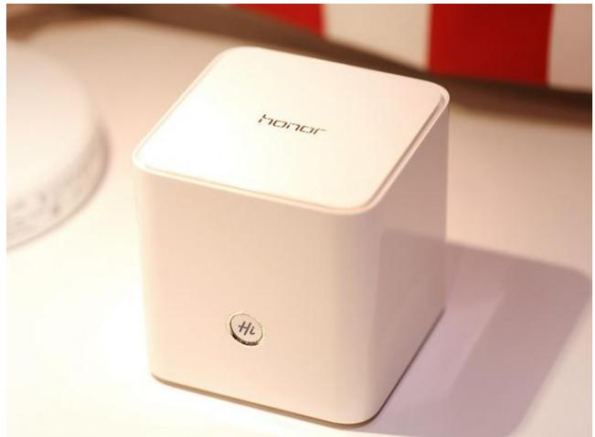
5GHz 网络，组成 1167MHz 的无线总带宽。采用双核心 1GHz 处理器，256MB 内存，具备 5 个千兆网络接口。荣耀路由 Pro 采用了高性能巴伦天线设计，集成了四个信号放大器。售价 328 元。
