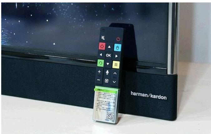
TCL 在高端机型中一直采用上图中的琴键式遥控器，这款 TV+至尊版 H8800 也同样如此。其最大的优点是将不同的功能按键以不同的颜色进行标注，便于识别。此外其每个按键的高度不同，可以完全进行盲操作。此外这个遥控器也支持空鼠、语音控制等功能。
