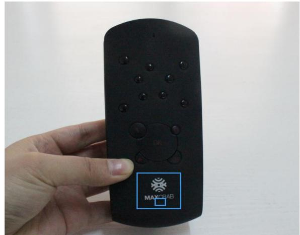
**点评：**巨蟹 T1 的遥控器本质上是它的主机，操控整个巨蟹 T1 上的内容、开关等。此款遥控器设有独特的触摸操控部分，而且上面的小按键还能当做确认键使用，此外还设有语音键和小窗键，这是其他头戴式头盔所不常见的，加之触控十分灵敏，小编真心有些爱不释手。
