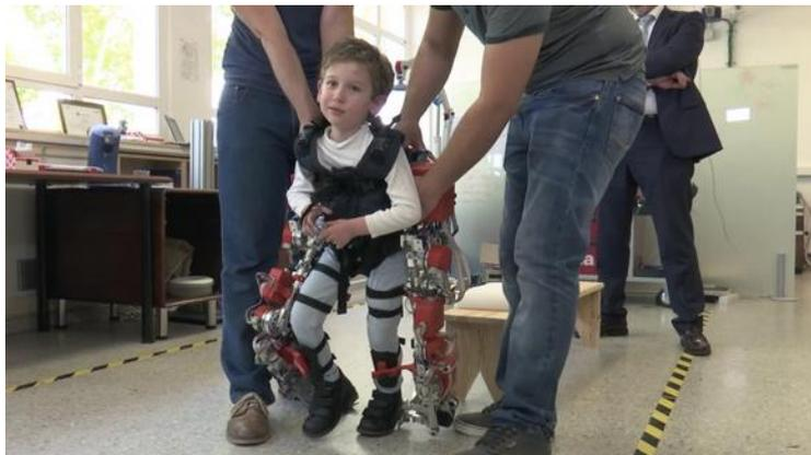
这款外骨骼由铝钛合金制成，重量为 26 磅，它在每条腿上安装了 5 个残疾人专用的马达，马达内置的传感器可以检测到“极其细微的移动倾向”，而且机载计算机还能根据孩子们的行走尽可能创建出平稳的机械步伐。此外，考虑到儿童的生长发育，整个设备采取了伸缩支架的设计，可根据患者身高调整，以帮助孩子们行走，避免卧床不起引起更严重的并发症。
