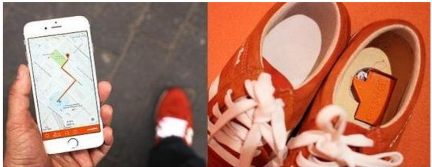
向导，每走到一个岔路口就能够告知用户下一步该往什么方向前进，通过振动来对用户指示方向。easyJet App 提供的导航服务是由 Google Maps 和 Google Map Direction 的 API 提供技术支持的。鞋子当中连接 GPS 和用户手机的数据通讯收发装置被安装在了运动鞋的鞋垫和鞋底之间，由一个 3D 打印的塑料外壳保护，避免设备在用户行走的过程中被损坏，脚底流汗等外界因素对它也不会造成影响。
